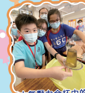
大氣壓力令杯中的水不能流下來，真神奇！
